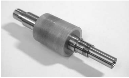
図 6 グラスファイバー補強が施された永久磁石回転子 Fig. 6 Photographs of PM rotor reinforced by grass fiber.
