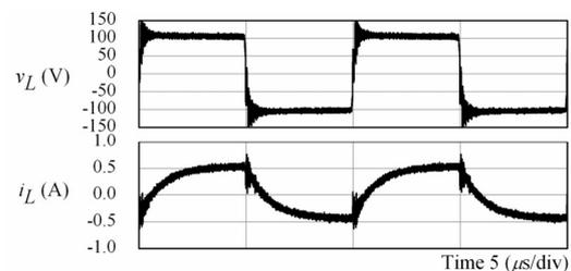
図 4 提案回路の出力波形
