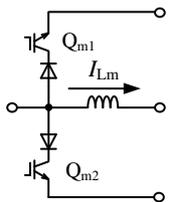
Fig. 4. Inductor module.
